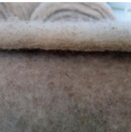
**Nutzungsmöglichkeiten** Der Flaum aus den *Typha*-Kolben wird zunächst von den Samen getrennt. Dieses Material wird anschließend für die Herstellung eines Vliesstoffs verwendet. Dafür wird Wolle im Verhältnis 50:50 beigemischt. Der Vliesstoff kann als Füllmaterial/Isolierung in Kleidung oder als Verpackungsmaterial für hochqualitative Produkte eingesetzt werden.
