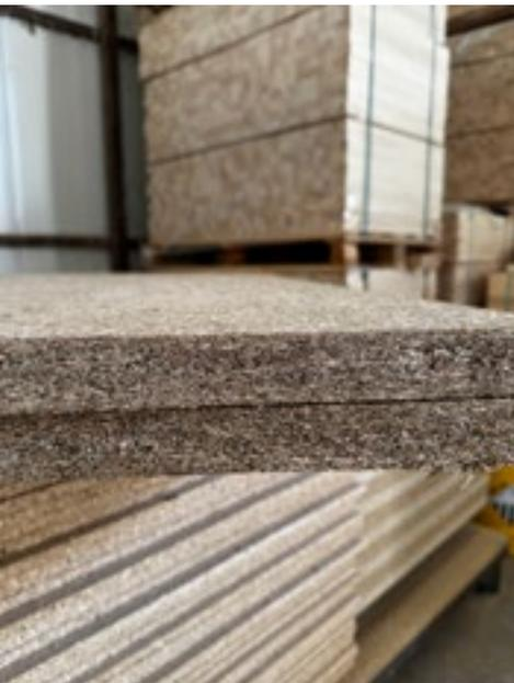
**Nutzungsmöglichkeiten** Herstellung von Platten aus Paludi-Seggen-Gras mit natürlichem Bindemittel, welche als Füllung für Innenraumtüren geeignet sind.
