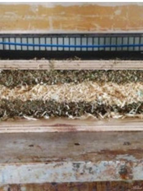
**Nutzungsmöglichkeiten** Das Material kann als Plattenmaterial im Innenbereich von Gebäuden verwendet werden. Untersuchungen zeigen, dass bis zu 75 % Ufer-Segge (*Carex riparia*) beigemischt werden können, ohne dass sich die Materialeigenschaften verändern. Bei einem höheren Anteil verschlechtern sich die mechanischen Eigenschaften. Es wurden bislang nur kleine Testplatten gefertigt.
