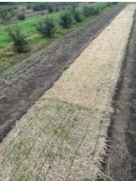
**Nutzungsmöglichkeiten** Die Paludimatte besteht aus einem Paludi-Faservlies, welches oben und unten in Trägernetzen aus Jute eingefasst ist. Alle Komponenten werden mittels Jutfäden vernäht. Je nach Flächengewicht dient die Paludimatte als Erosionsschutzmatte (bis 500 g/m<sup>2</sup>) oder als vollorganische Mulchmatte (ab 600 g/m<sup>2</sup>), zur Unterdrückung lichtkeimender Gräser und Pflanzen.
